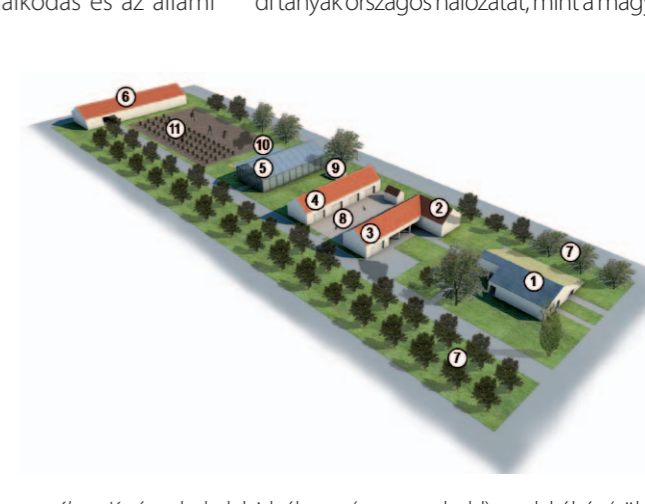
5. ábra • Kerített beltelkek ideálterve (1 magyar hold) • 1 – lakóház (zöldtető vagy zsúp-, nádfedés és napkollektor); 2 – nyári konyha; 3 – gépkocsi tároló; 4 – istálló; 5 – fólia vagy üvegház; 6 – gazdasági épület; 7 – gyümölcsös; 8 kisállattartás; 9 – komposzt; 10 – fűrt kút és tó; 11 – zöldségeskert.
